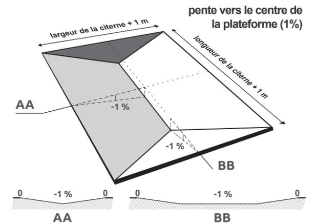
Sol propre et stabilisé + lit de sable (0/2) 10 cm (+/- 2 cm)
